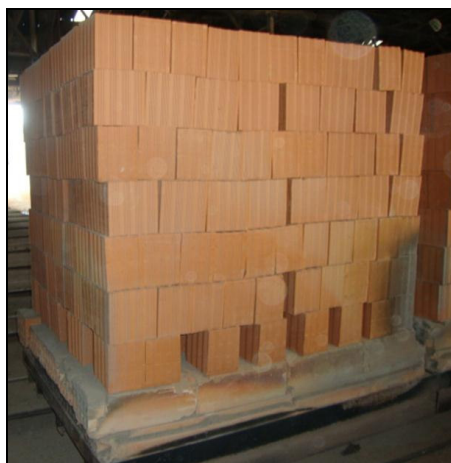
Figura 4.12. Tijolos Fabricados com a Adição do Resíduo Lama do Hidrofiltro.
