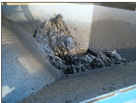
Figura 4.1. Característica Física do Resíduo Lama do Hidrofiltro – Caçamba 508 da Linha E II da Fundição de Blocos.
