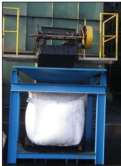
Figura 4.11. Processo de Secagem da Lama do Hidrofiltro.
