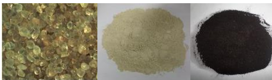
Areia base (Sílica) Bentonita (Argila) Pó de carvão mineral Figura 2: Matérias primas da Areia de Moldagem.
