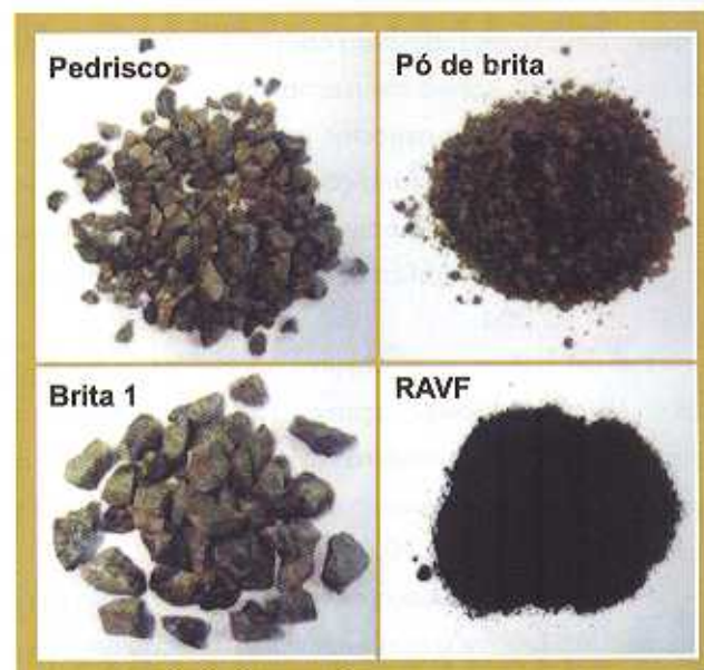
Figura 2.1 Materiais utilizados no Concreto Asfáltico.
