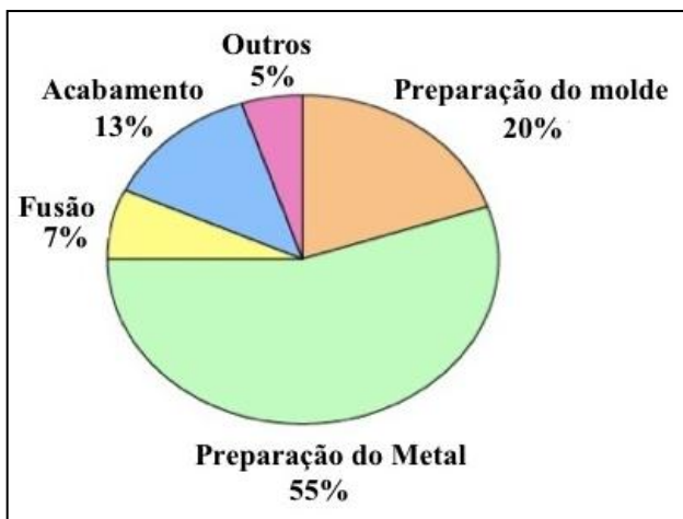
Figura 7. Energia necessária para cada etapa do processo de fundição. A energia total necessária é de entorno 10 MBTU/t, mas varia por metal e tipo de forno usado. Fonte: (DALQUIST e GUTOWSKI, 2004) (traduzido)
