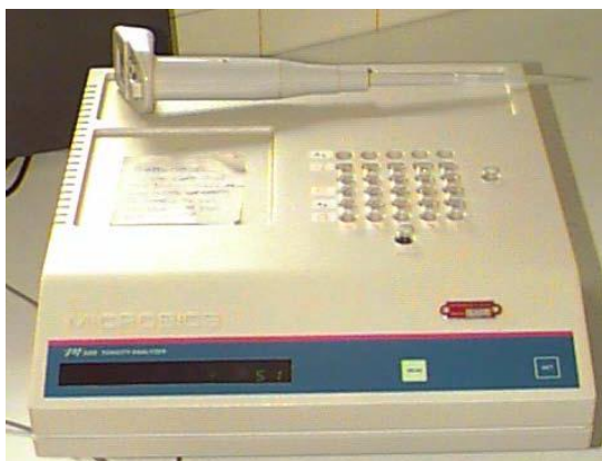
Figura 17. Exemplo de Luminômetro: equipamento utilizado no ensaio de toxicidade aguda com Vibrio fischeri . Foto: HAMADA (2008)
